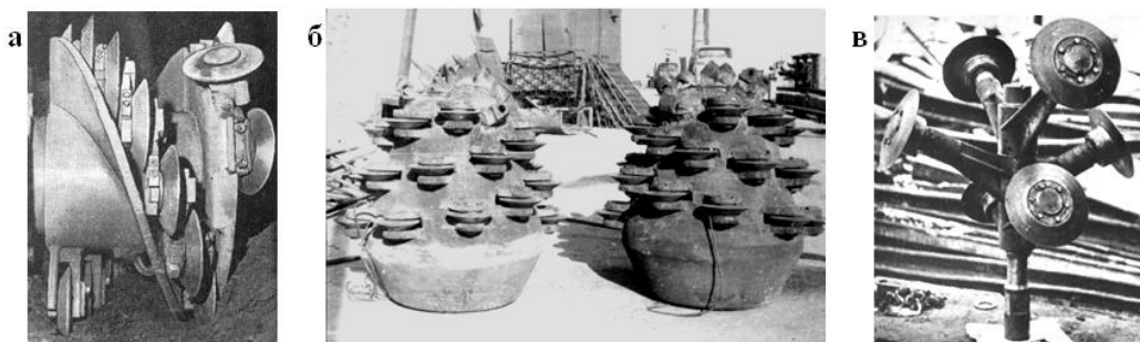
Рис. 1. Исполнительные органы горных машин, оснащенные дисковыми инструментами: а – шнек; б – коронки; в – расширитель
