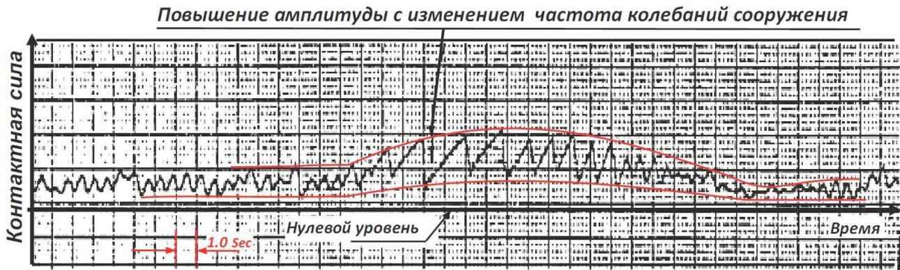
**Рис. 1.** Записи сил давления льда на реальные сооружения по К.А. Blenkarn [18].
