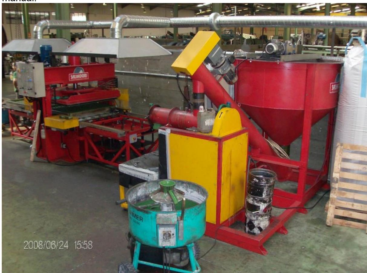
**Figura 1:** Equipamento para a produção industrial de pavimento Antichoque bicolor
