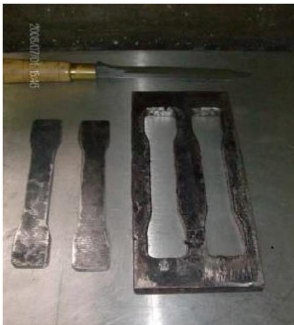
Figura 15: Molde e faca utilizada na desmoldagem dos provetes de tração
