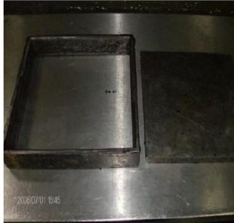
**Figura 14:** Molde e tampo utilizada na produção do aglomerado de borracha
