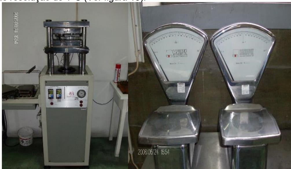
Figura 13: Equipamento utilizado na produção de provetes para tração e aglomerados de borracha. Balanças Cachapuz (direita) e Prensa Gibitre (esquerda).
