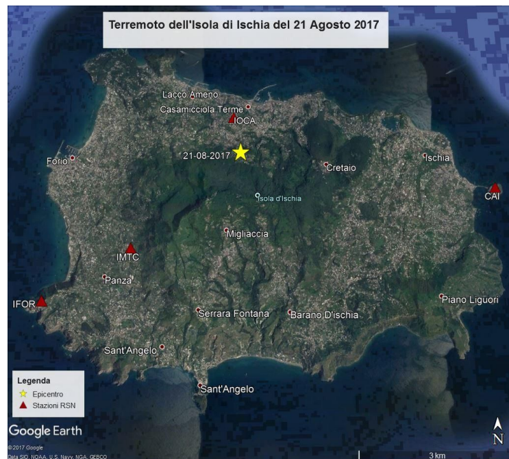
Figura 3.3.2-1. Ubicazione dell'epicentro (localizzazione a cura di INGV-OV) e delle postazioni di registrazione. Alle stazioni IOCA, IMCT e IFOR sono affiancate stazioni velocimetriche a corto periodo analogiche.
