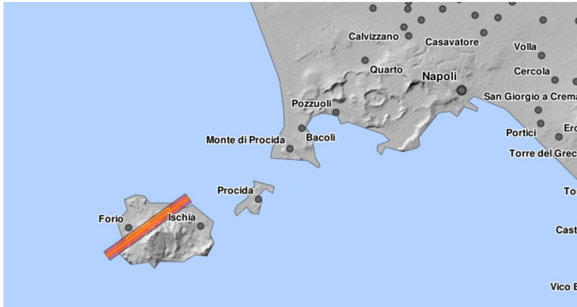
Figura 1.4-1 La sorgente sismogenetica proposta per il terremoto del 1883 è una faglia con direzione NE-SW che delimita a nord-ovest il rilievo del Monte Epomeo. Si tratta di un elemento molto superficiale, con dip elevato e cinematica estensionale pura. La sorgente ITIS068 ha una lunghezza di 5 km e una larghezza di 3.5 km. Queste dimensioni sono coerenti con una M_w di 5.4.
