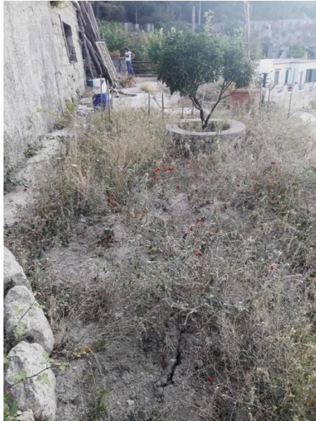
Foto 12. Frattura continua dal terreno coltivato fino ai manufatti (a sinistra). Dettaglio della frattura nel terreno coltivato (a destra).
