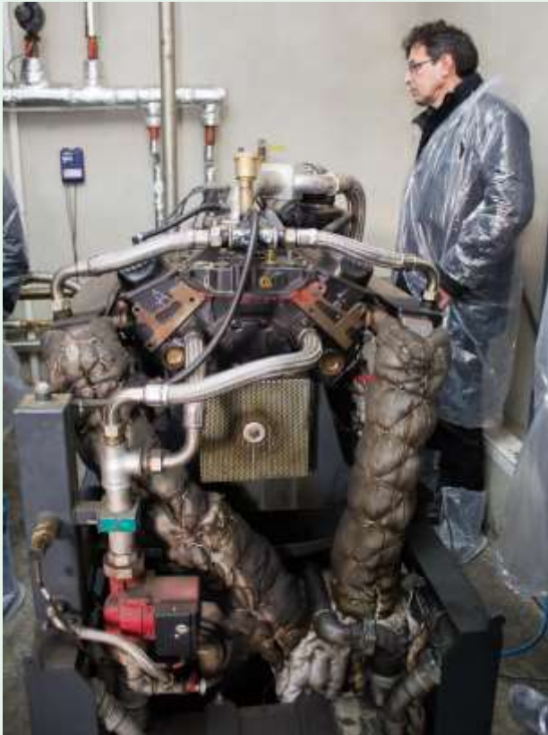
Kuva 21. Generaattori tuottaa puukaasusta sähköä. Valokuva Harri Hakala
