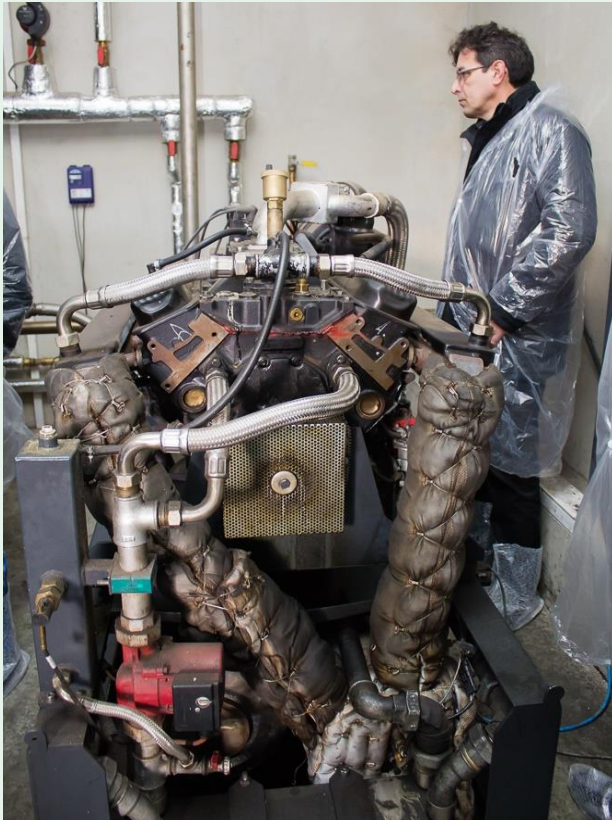
Kuva 21. Generaattori tuottaa puukaasusta sähköä. Valokuva Harri Hakala
