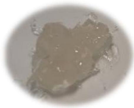
Fig. 1. Ejemplo de grasa lubricante obtenida a partir del electrohilado de material lignocelulósico.
