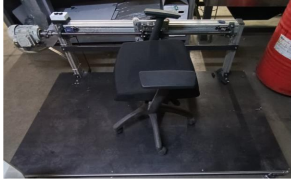
Şekil 7. TS EN 1335-3 standardınca imal edilmiş deney düzeneği görseli
