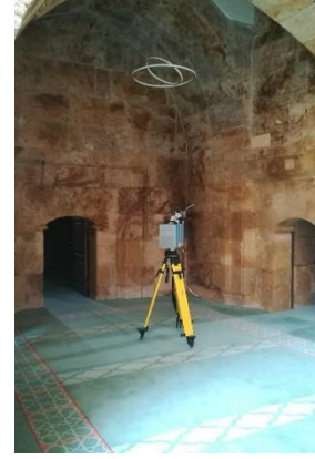
Şekil 2. Kırşehir İli Cacabey Medresesi 3D Lazer Tarama Uygulaması
