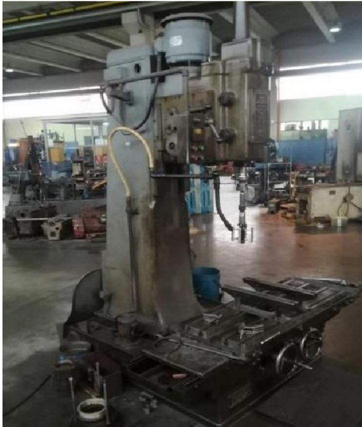
Şekil 1.b Dikey Matkap Tezgahı (Samsun Segman ve Gömlek San.ve Tic.Ltd.Şti. İzniyle)
