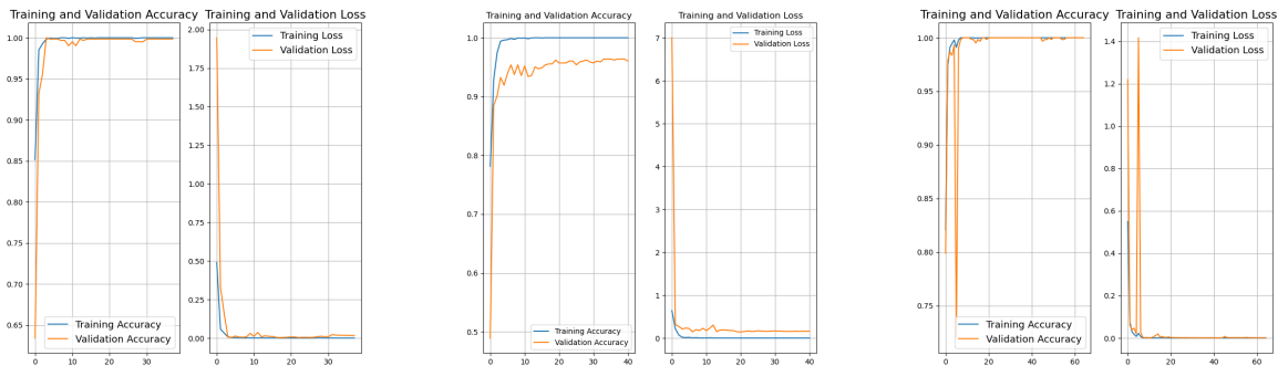
Abbildung 4.3: Trainingsgraf und Verlauf des Loss und der Accuracy für die Single Input Modelle. Orange - Training, Blau - Validierung. Links - Vorderseite | Mitte - Rückseite | Rechts - Merged
