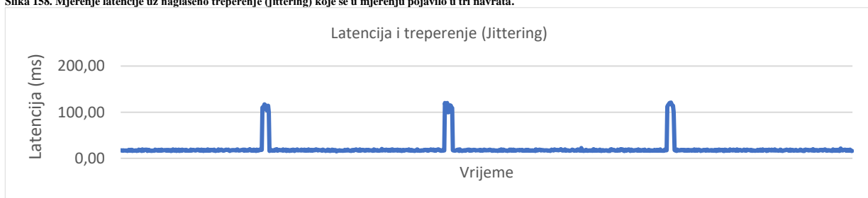
Slika 158. Mjerenje latencije uz naglašeno treperenje ( jittering ) koje se u mjerenju pojavilo u tri navrata.
