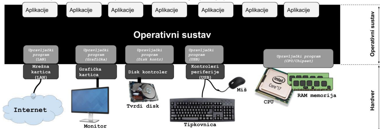
Slika 251. Instalacija operativnog sustava instaliranog direktno na hardver s vidljivim upravljačkim programima (Engl. Drivers ).
