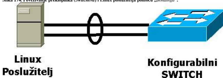
Slika 174. Povezivanje preklopnika ( Switcheva ) i Linux poslužitelja pomoću „ Bondinga “.
