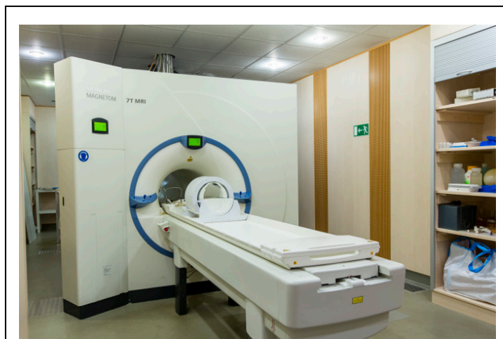
Die 7-Tesla-MRT-Geräte (hier das im Text beschriebene Gerät in Essen) sehen aus Patienten- bzw. Probandensicht weitgehend genauso aus wie klinisch übliche MRT-Geräte mit Magnetfeldern zwischen 0,3 und 3 Tesla.
