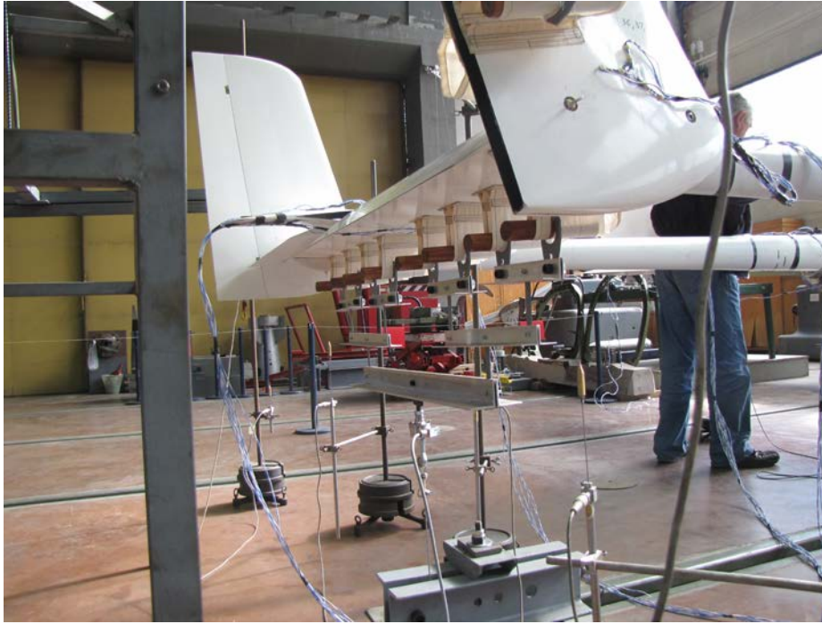
Сл. 4 – Начин уградње и увођења оптерећења у хоризонтални реп
