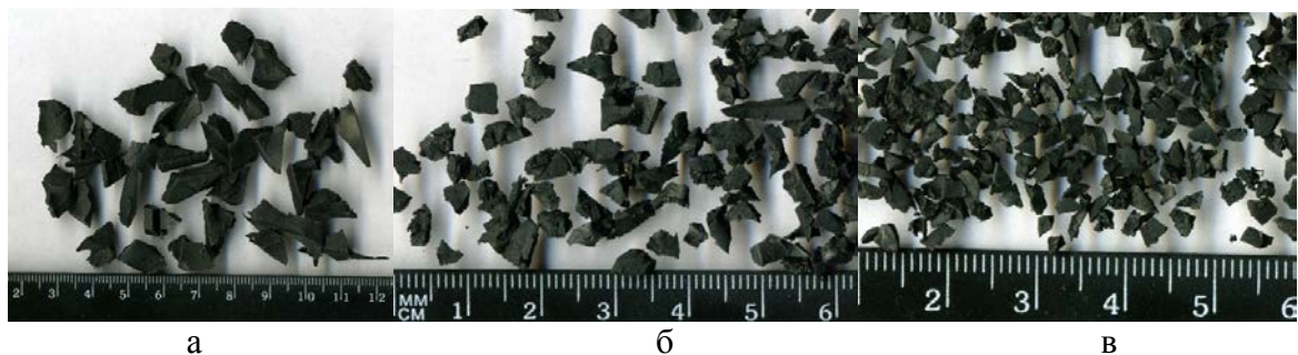
Рисунок 1 – Фракції подрібненої гуми: а – 10 мм; б – 5 мм; в – 2 мм
