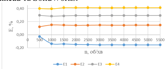
Рисунок 3 – Графіки відносної похибки значень максимальних реакцій у КП механізму, отриманих з аналітичного розрахунку та графічним моделюванням в SolidWorks, залежно від частоти обертання головного вала швейної машини
