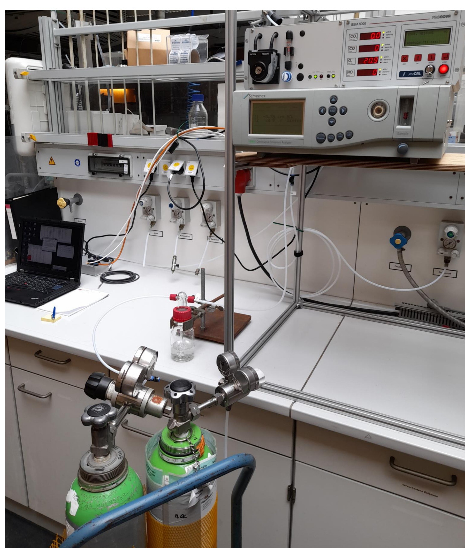
Abbildung 4: Gasmessgeräte, die an Kalibrierprüfgasflaschen angeschlossen sind.
