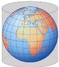
I en sylinderprojeksjon blir jordoverflata avbildet på en sylinderflate. Kartet blir flateriktig bare langs berøringssirkelen, i dette tilfellet ved ekvator.
