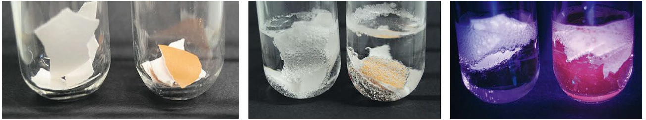
Abbildung 1 – links: Eierschalen vor Behandlung; Mitte: Gasentwicklung in Essigessenz; rechts: unter UV-Bestrahlung ( \lambda \approx 365 \text{ nm} ) [manueller Weißabgleich zur Minderung blauvioletter Strahlung der LED; f/5.6 , t = 2'' ]
