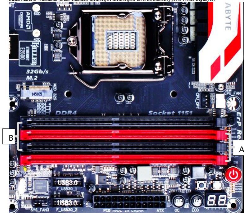
Slika 92.A. Dvokanalna (Dual-channel) memorija i memorijski utori na matičnoj ploči tvrtke Gigabyte.
