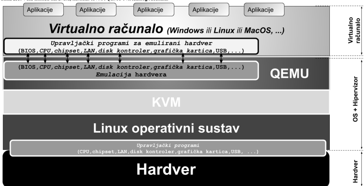
Slika 253. Veza između hardvera, kernela: KVM i QEMU i virtualnog računala.
