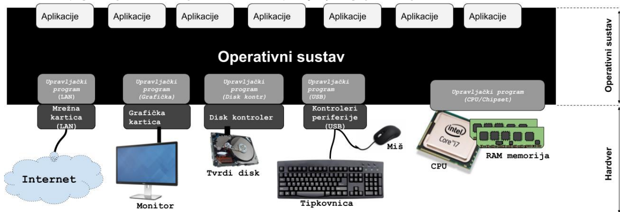
Slika 251. Instalacija operativnog sustava instaliranog direktno na hardver s vidljivim upravljačkim programima (Engl. Drivers ).
