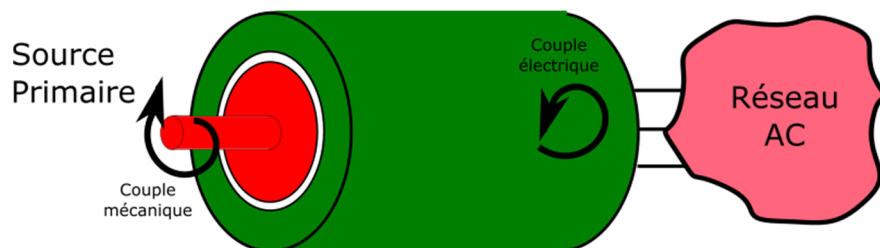
Figure 1 : Schéma simplifié d'une machine synchrone raccordée au réseau alternatif (AC).
