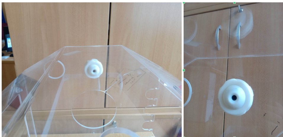
1.1. Ábra: A 3D nyomtatott kamera amelyet a MEDICOR beépített az inkubátor falába. Így a kamera fix pozícióból nézheti az inkubátorban lévő csecsemőt.
