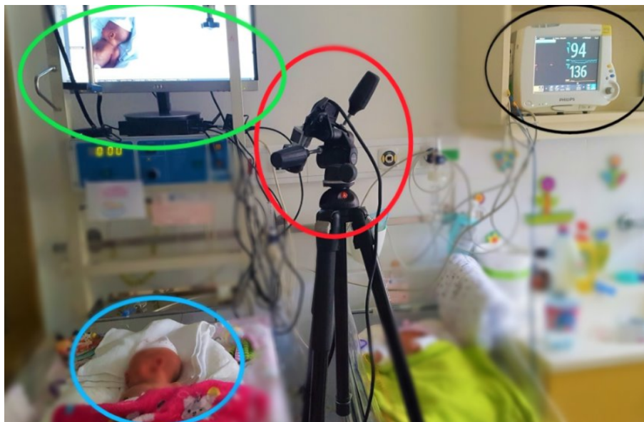
3.1. Ábra: Egy látható fény tartományban működő Basler kamerával (piros) figyeli meg az inkubátort és a benne lévő csecsemőt (kék) és továbbítja az adatokat egy laptopnak vagy mini PC-nek (zöld). Eközben csatlakoztatva van a kórházakban használt Philips IntelliVue MP20/MP50 monitorra (fekete) amely pulseoxymeter-rel és EKG-val méri a pulzust és a légzést. Majd a mért adatokat feltöltjük egy adatbázisba.
