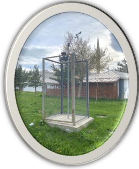
Şekil 4. Ölçüm cihazı: Davis Vantage Pro 2
