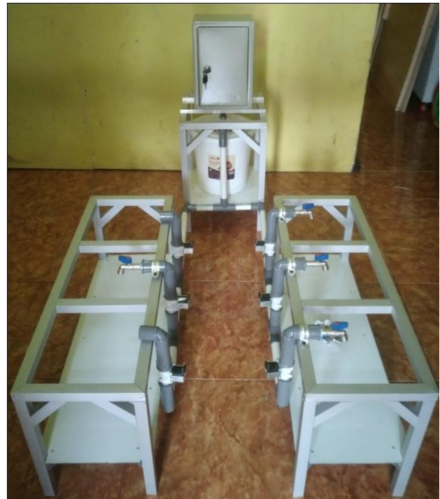
Gambar 13. Desain Alat Penyiraman Tanaman Otomatis
