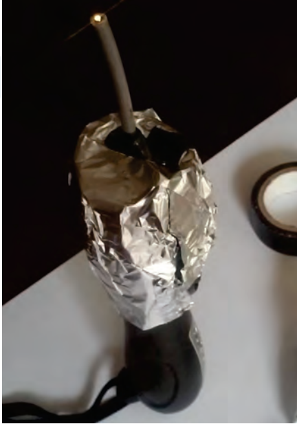
Fig. 16: estrella artificial con una linterna y un trozo de fibra óptica.
