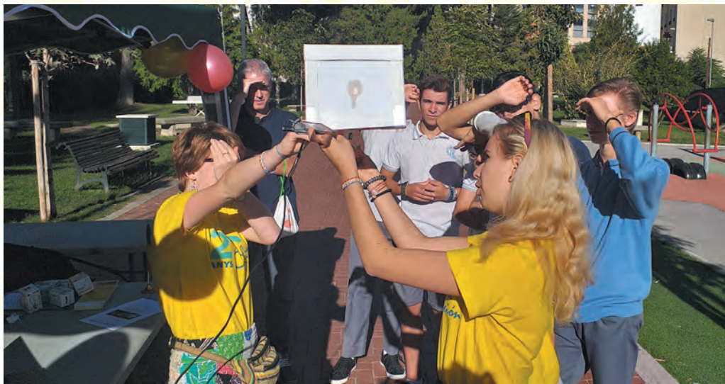
Obteniendo la Potencia del Sol con el papel manchado de aceite y una bombilla. En esta foto podemos ver la mancha de aceite.
