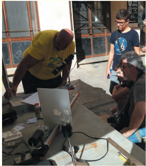
Uso del dispositivo de Jacob adaptado para medir la Potencia dl Sol. Podemos ver la bombilla al final de la pieza principal y el PCV blanco perpendicular a ella.
