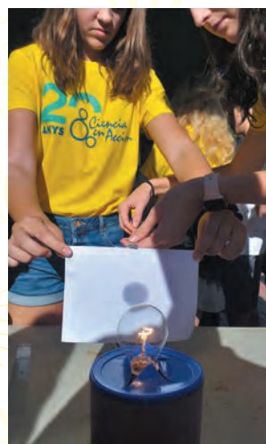
Fotómetro Bunsen con el papel de aceite y detalle de la mancha de aceite.
