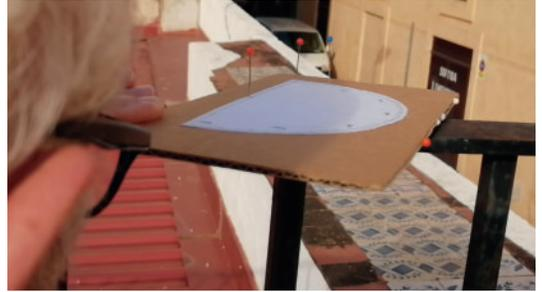
Fig. 4. Goniómetro, sirve para los ángulos horizontales.
