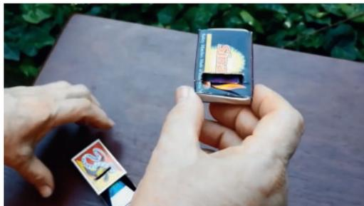
Fig. 11. Espectroscopio de caja de cerillas. Con un trozo de CD.
