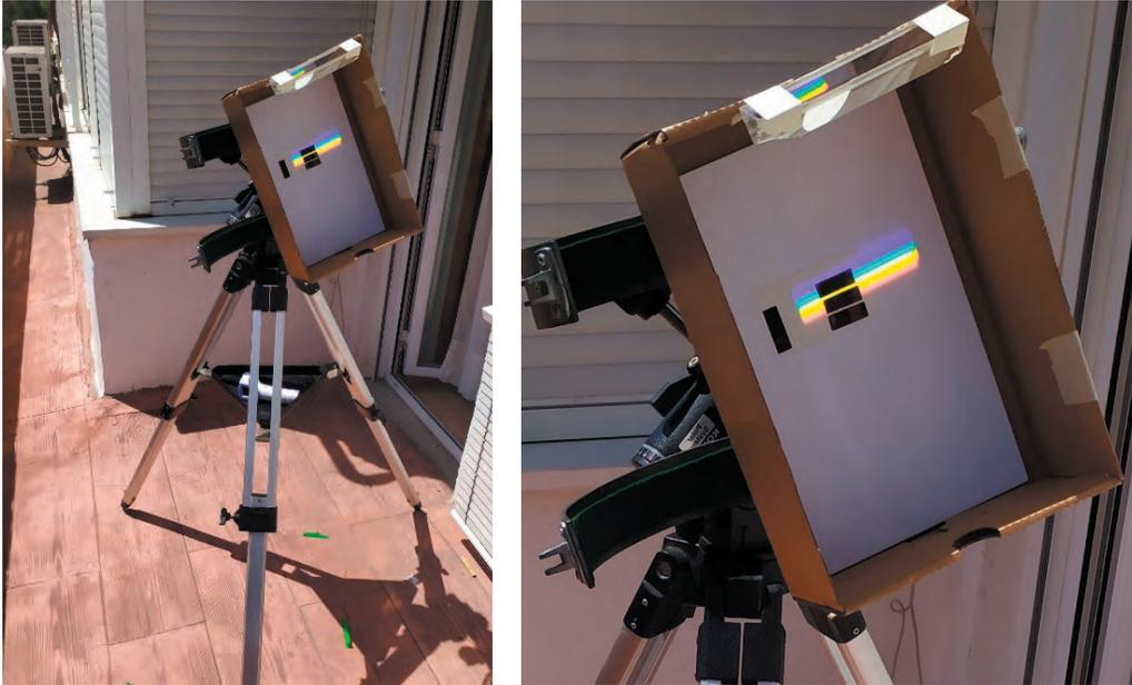
Fig. 47: Caja sobre una montura ecuatorial de un telescopio (izquierda). Detalle de la caja (derecha).
