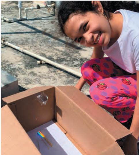
*Fig. 6: Caja con el prisma y los cuatro termómetros en Santo Domingo, República Dominicana*
