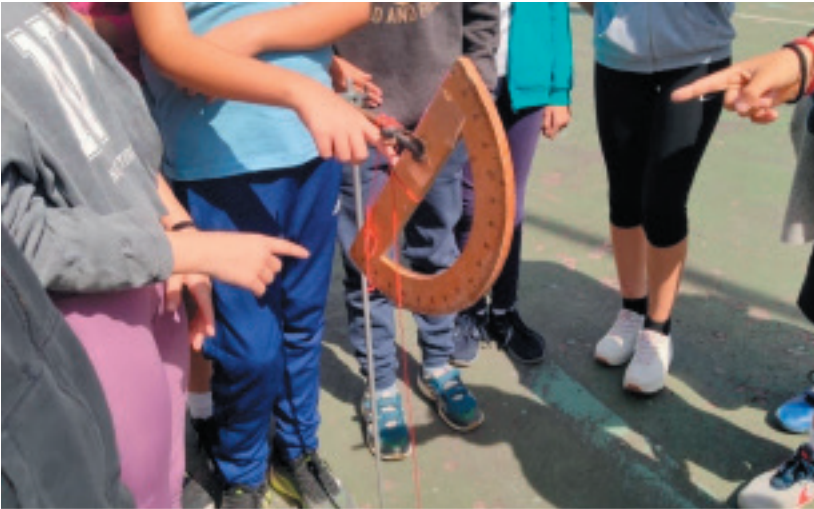
Fig. 9: Con un semicírculo orientado hacia el sol, podemos obtener la altura del mismo (1st Experimental Junior High School of Maroussi, Greece (Crédito: V. Petridou).
