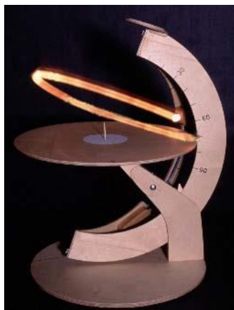
Fig. 25a: Simulador de mayor tamaño hecho en madera. Fig. 25b: Con una cámara fotográfica y una larga exposición es posible simular la trayectoria solar. Fig. 25c: Simulador estelar en madera (Fotos: Sakari Ekko).
