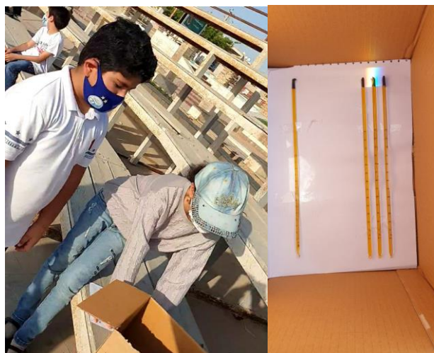
Fig 4: Estudiantes tratando de encontrar el infrarrojo con termómetros y un prisma.
