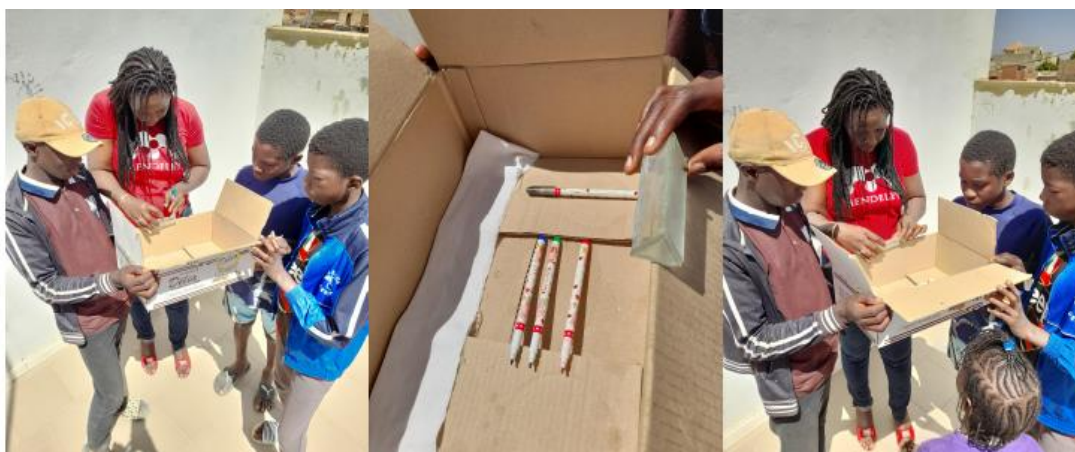
Fig. 1: Primera configuración del experimento de Herschel con un prisma artesanal en marzo de 2021
