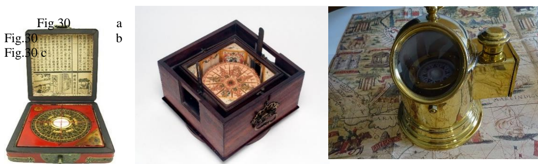
Fig.30, a, b, c: Tres instrumentos dedicados a la obtención de los ángulos (rumbos) en el mar o en tierra, siendo el 30 c, el usado en el mar denominado aguja de marear
