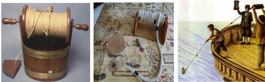
Fig. 39: Corredera náutica. Fuente Wikipedia, Fig.40: Barquilla de elaboración propia, Fig.41: Iniciando la operación con los tres instrumentos Fuente Wikipedia
