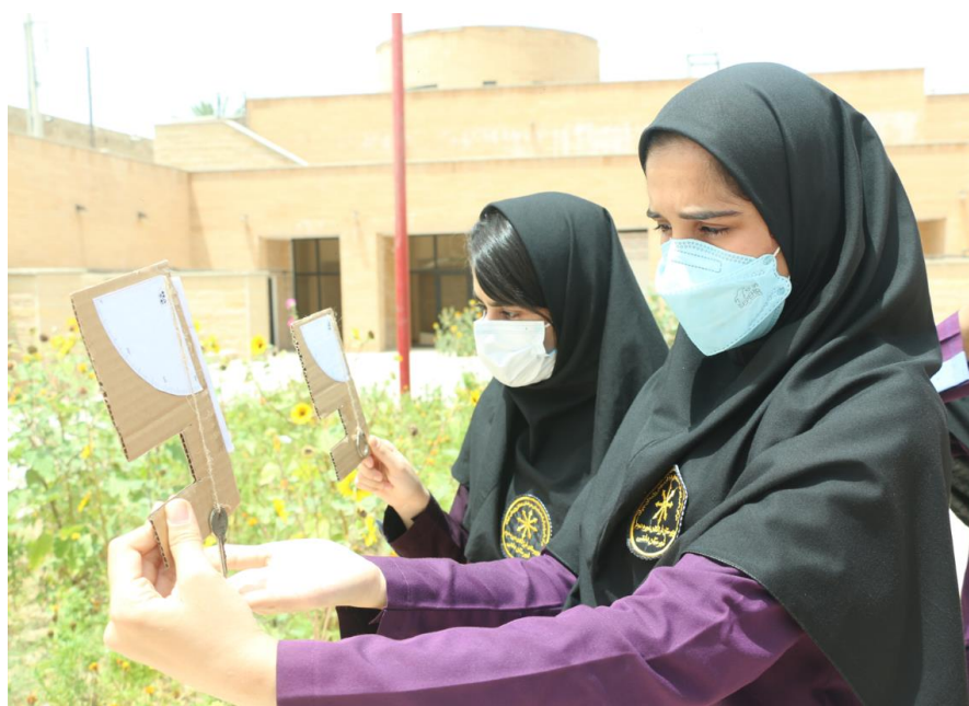
Fig. 3: Obtención de la altitud del Sol en el mediodía solar
