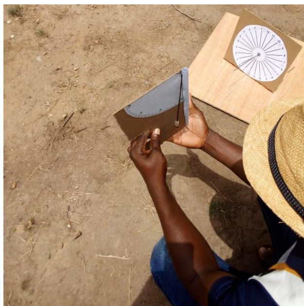
Fig 2: Determinar la altura del Sol con un simple cuadrante
