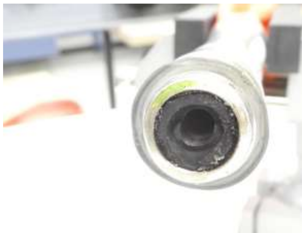
Blaas C7; een detail van het afgebroken deel van de aansluiting
