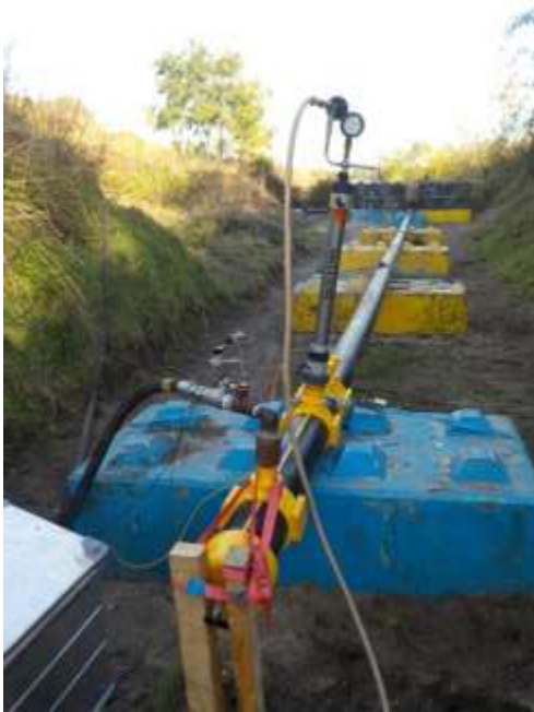
Foto 10 en Foto 11 De meetopstelling zoals gebruikt met het zetten van een blaas in geval van een gasbrand.
