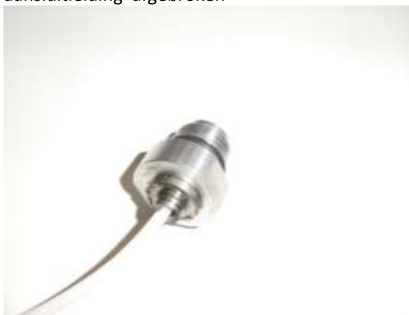
Blaas C7; Bij meting 21 (directe ontsteking waterstof in een 20 meter leiding) is de aansluitleiding afgebroken
