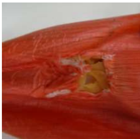
Blaas C1; een gat ontstaan als gevolg van een te hoge temperatuur
