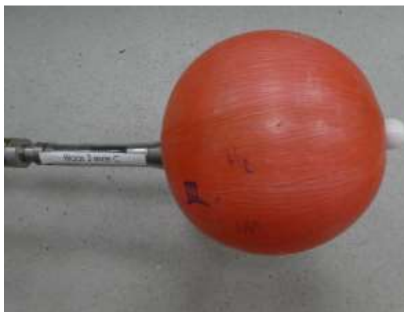
Blaas C3; de blaas is op druk te brengen en te houden (akkoord)
