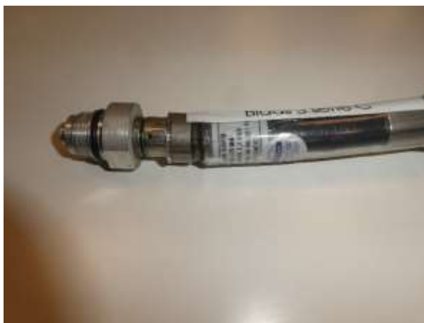
Blaas C3; beschadigd bij meting 3 – directe ontsteking van waterstof, een beschadiging bij de lans aansluiting (smeltschade)
