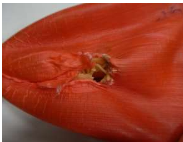
Blaas C2; een gat ontstaan als gevolg van een te hoge temperatuur
