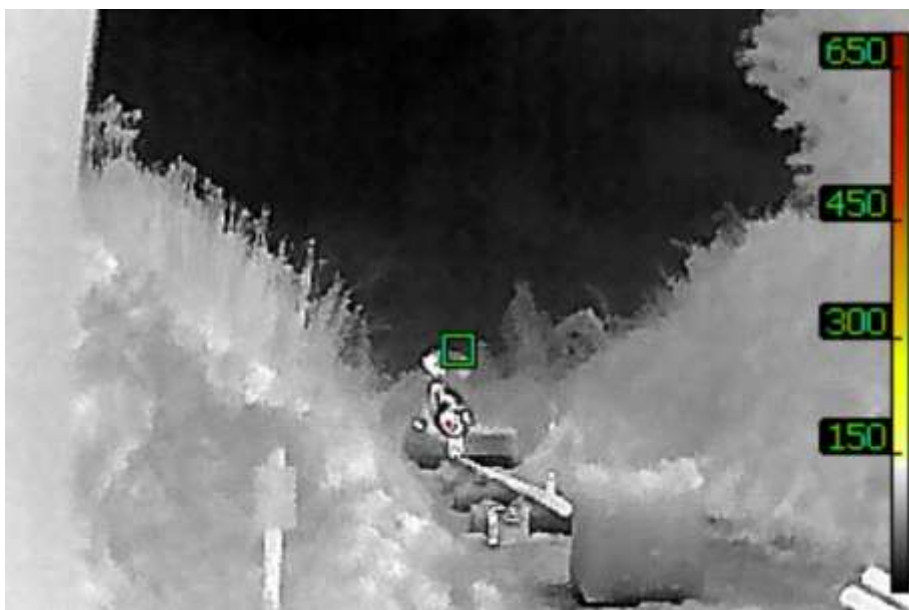
Foto 18: Warmtebeeld meting 34 (8m 3 /h aardgas)
