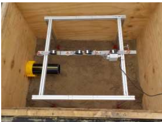
Foto 8 Verhoogde posities van vonkontstekers voor de test met vertraagde ontsteking
