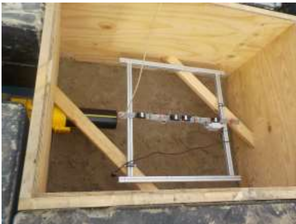
Foto 4 en Foto 5 De positie van de vonkontstekers.
