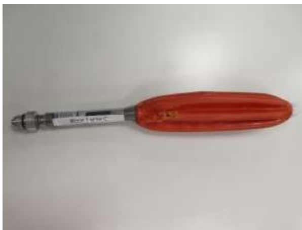
Blaas C1; beschadigd bij meting 1 – directe ontsteking van aardgas
