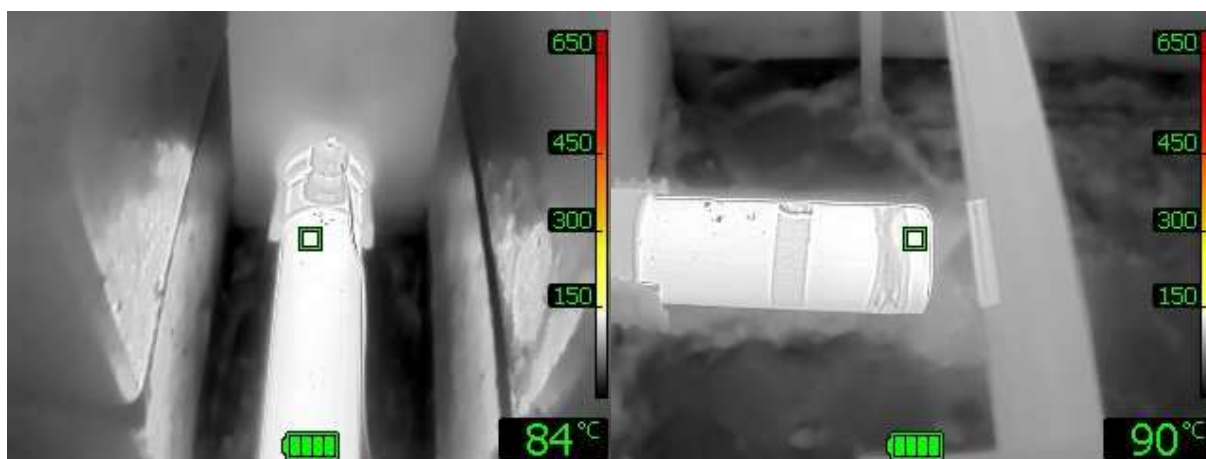
Foto 16: Warmtebeeld na meting 30, links gemeten direct buiten de werkput, rechts in de werkput
