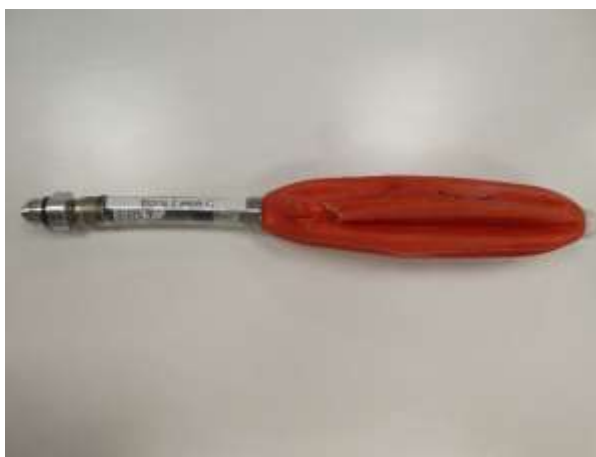
Blaas C2; beschadigd bij meting 2 – directe ontsteking van aardgas
