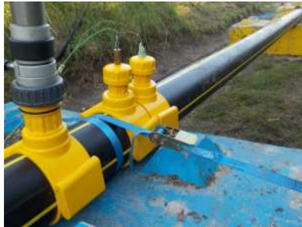
Foto 10 en Foto 11 De meetopstelling zoals gebruikt met het zetten van een blaas in geval van een gasbrand.
