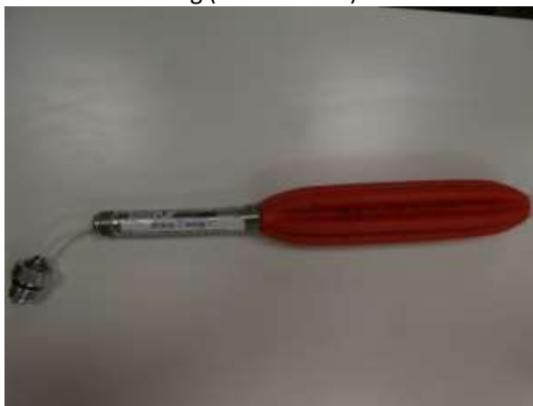
Blaas C7; Bij meting 21 (directe ontsteking waterstof in een 20 meter leiding) is de aansluitleiding afgebroken
