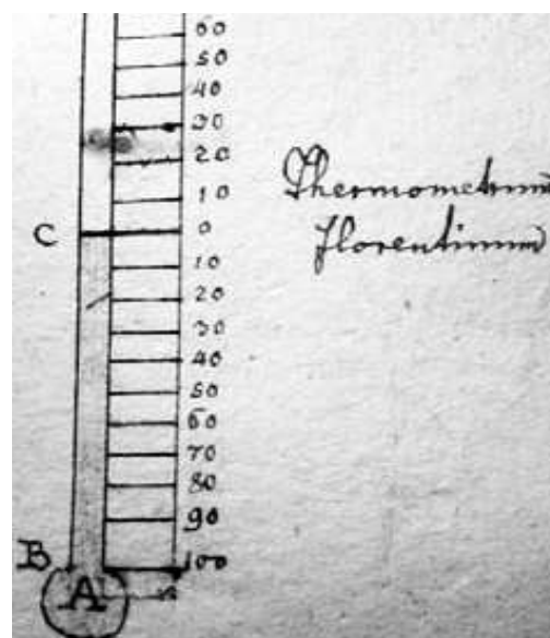
Figure 6-202: Zinsmeister’s sketch of the thermometer (Zinsmeister, 1799, 1:19).
