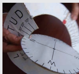
Рис. 17а и 17б. Восход Солнца в Гандии (Испания) 41^\circ с.ш. Угол солнечной тропы относительно горизонта равен 90^\circ минус значение широты. (Фото: Роза М. Рос, Испания). M. Ros, Espanya).
