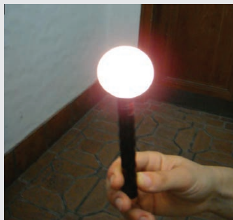
Рис. 15а: Фонарик с удаленным защитным колпачком Рис. 15б: Фонарик с теннисным шаром, моделирующий уличный фонарь
