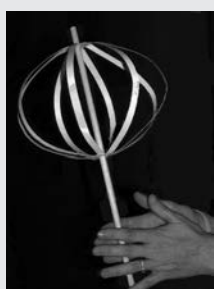
Рис. 11: Модель для имитации сплющивания из-за вращения.
