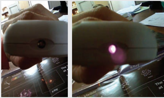
Рис. 10а: Активированный пульт, видимый глазами. Рис. 10b Активированный пульт через мобильный телефон
