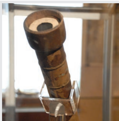
Рис. 7а: Один из двух уцелевших телескопов Галилея попал в Институт Франклина в Филадельфии в 2009 году во время его первого визита в Соединенные Штаты. Обратите внимание, что внешняя часть объектива прикрыта картонным кольцом. Скрывая внешнюю часть линзы, которая была наименее точной, Галилей улучшил качество своих изображений. (Фото: Джей М. Пасачофф).
