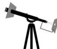
Fig. 10a: Observație solară cu proiecție printr-un telescop (nu vă uitați direct la Soare).
