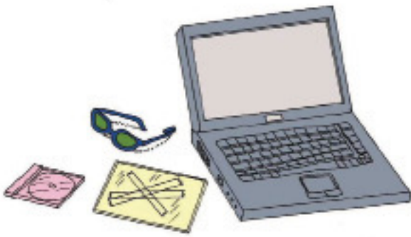
Fig. 6: Lumina de la monitorul TFT al calculatorului este polarizată, iar banda adezivă schimbă unghiul de polarizare. Putem observa diferite culori când folosim ochelari polarizați
