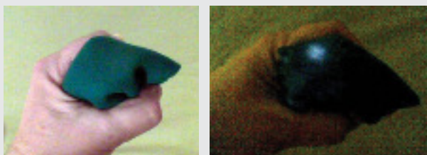
Fig. 12a și 12b: Pâslă blochează lumina vizibilă, dar nu blochează radiația în infraroșu
