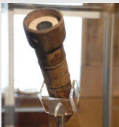
Fig. 7a: Unul dintre telescoapele lui Galileo care au supraviețuit în timp a ajuns la Franklin Institute în Philadelphia în 2009. De reținut că partea exterioră a lentilei este acoperită cu un inel de carton. Ascunzându-se partea exterioră a lentilei, care era partea cea mai puțin precis prelucrată, Galileo a îmbunătățit calitatea imaginilor sale. (Foto: Jay M. Pasachoff).
