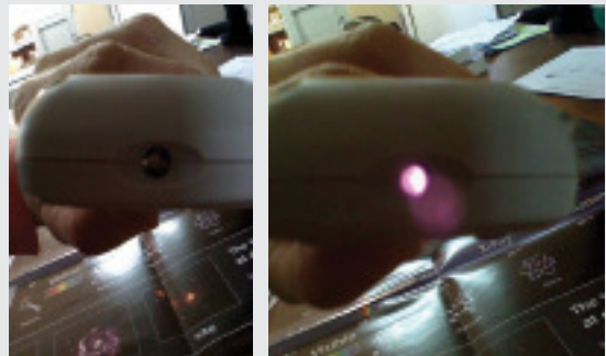
Fig. 10a Telecomanda activată privită cu ochiul liber. Fig. 10b Telecomanda activată, privită cu ajutorul camerei foto a mobilului
