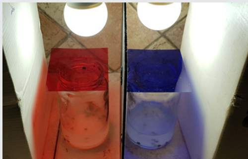
شکل ۱۷: محلول و لامپ به همراه فیلتر قرمز و آبی.
