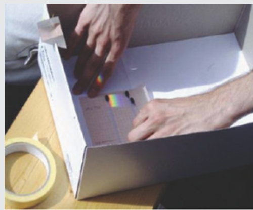
تصویر ۱-۹: قرار دادن سه دماسنج با حباب‌های مشکی در نواحی مختلف طیف در سایه
