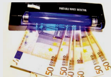
شکل ۱۹: آشکارساز پول جعلی که از نور فرابنفش استفاده می‌کند.
