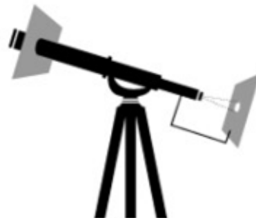
شکل ۱۰ الف: تصویر کردن خورشید به کمک تلسکوپ (هرگز به صورت مستقیم به خورشید نگاه نکنید).
