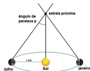
Fig. 2: L'angle de parallaxe p est le changement angulaire qu'on voit lors de l'observation d'une étoile à partir de deux emplacements qui sont séparés par une distance Terre-Soleil.
