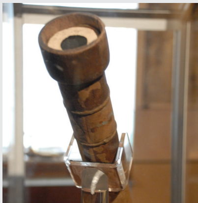
Fig. 7a: L'un des deux télescopes survivants de Galileo est arrivé à l'Institut Franklin de Philadelphie en 2009, lors de sa première visite aux États-Unis. Notez que la partie extérieure de l'objectif est recouverte d'un anneau en carton. En cachant la partie la plus marginale de l'objectif, Galileo a amélioré la qualité de ses images. (Photo par Jay M. Pasachoff).
