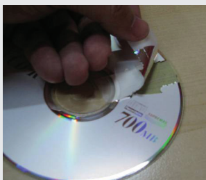
Fig. 3b: Retrait de la couche métallique du CD, avec du ruban adhésif.
