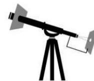
Fig. 10a: Observation solaire par projection avec un télescope.
