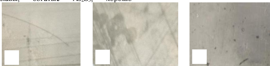
Рис. 1. Микроструктуры сплавов системы \text{As}_2\text{S}_3 - \text{TlGaSe}_2 . а)-15 мол. %, б)-50 мол. %, в)-90 мол. % \text{TlGaSe}_2 .
