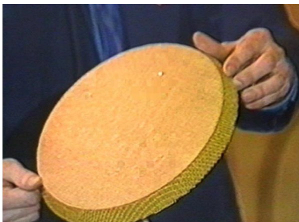
Рис. 7. Деталь из ПСП, полученная с использованием режущих пластин.
