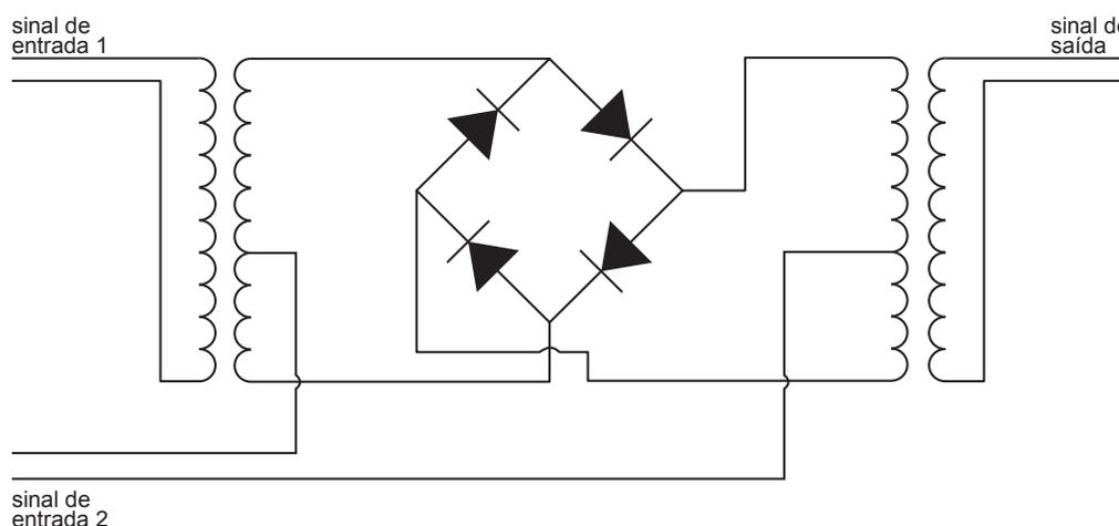
Figura 1 - Circuito com diodos (►) em anel que permite realizar eletronicamente a modulação de amplitude (ou "mixagem de frequências") que dá nome à técnica da *modulação em anel*.
