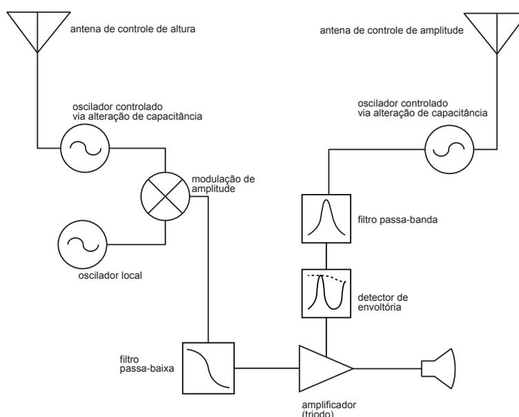
Figura 2 - Diagrama do mecanismo eletrônico de um Theremin.
