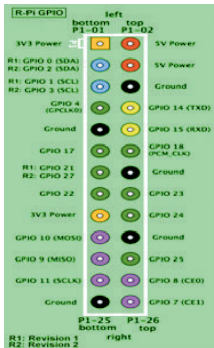
Figura 2. Asignación de pines GPIO en la Raspberry Pi Modelo B, rev 1 y Modelo B, rev 2 (General Purpose Input/Output (GPIO), 2015)
