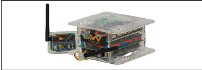
Abbildung 2: Messsystem für Energieverbrauch
