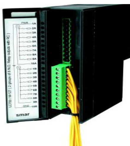
Figura 3 - Conexão traseira de entradas e saídas do CLP LC700CP
