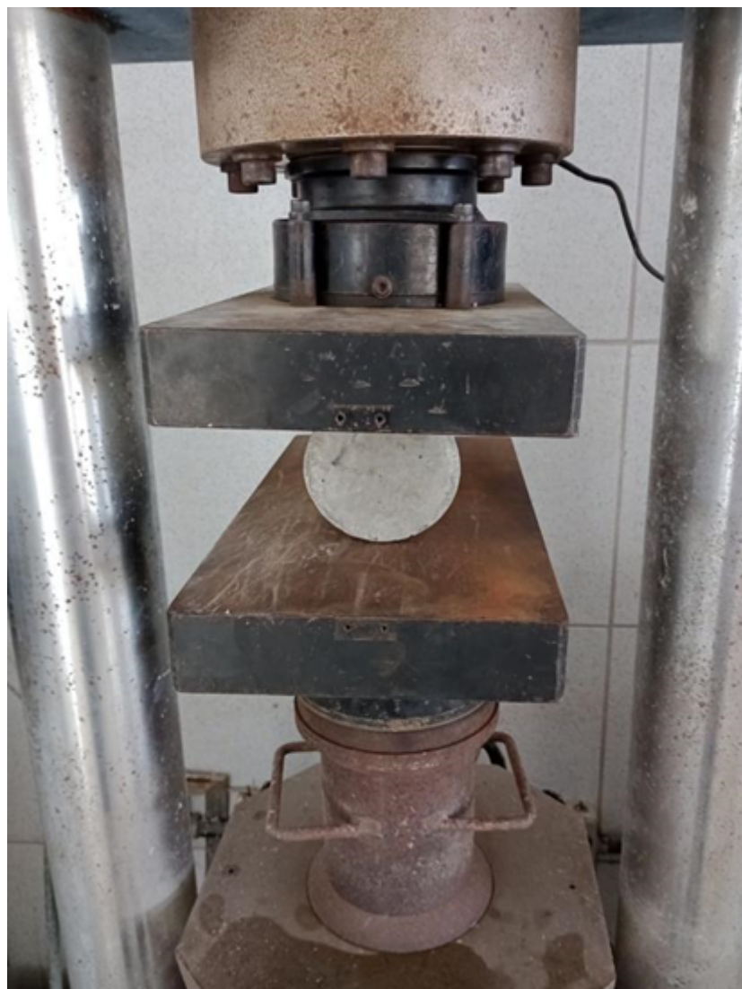
Figura 4 – Rompimento por tração, para abertura dos corpos de prova
