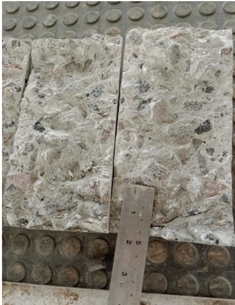
Figura 5 – Corpos de prova rompidos e absorção de água exposta
