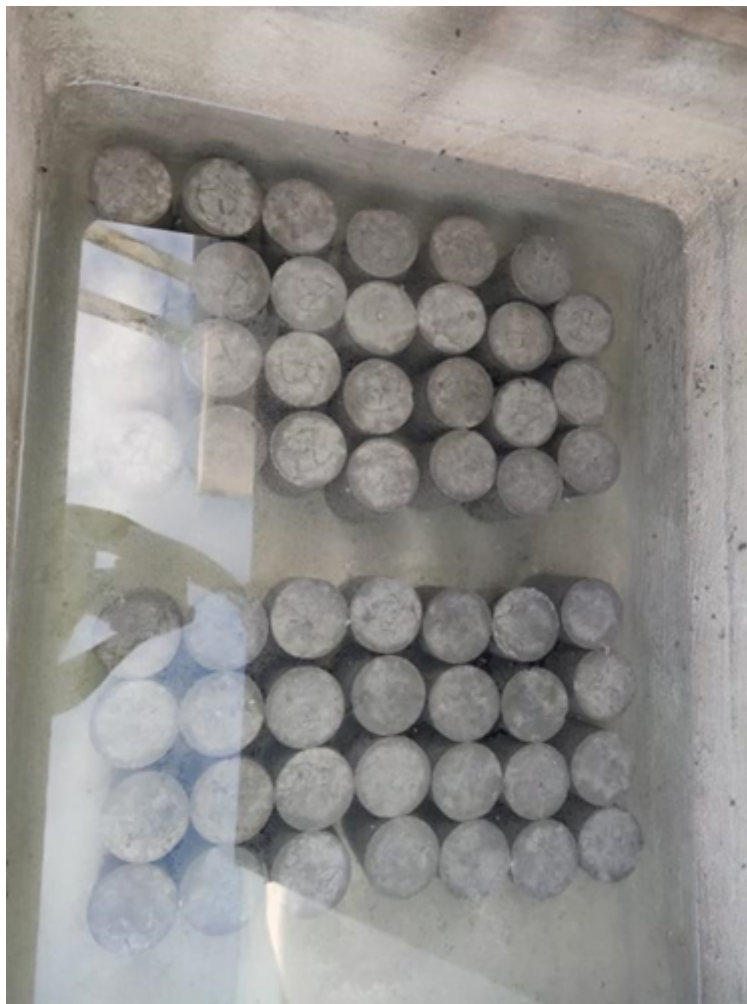
Figura 3 – Corpos de Prova submetidos à cura em tanque de água
