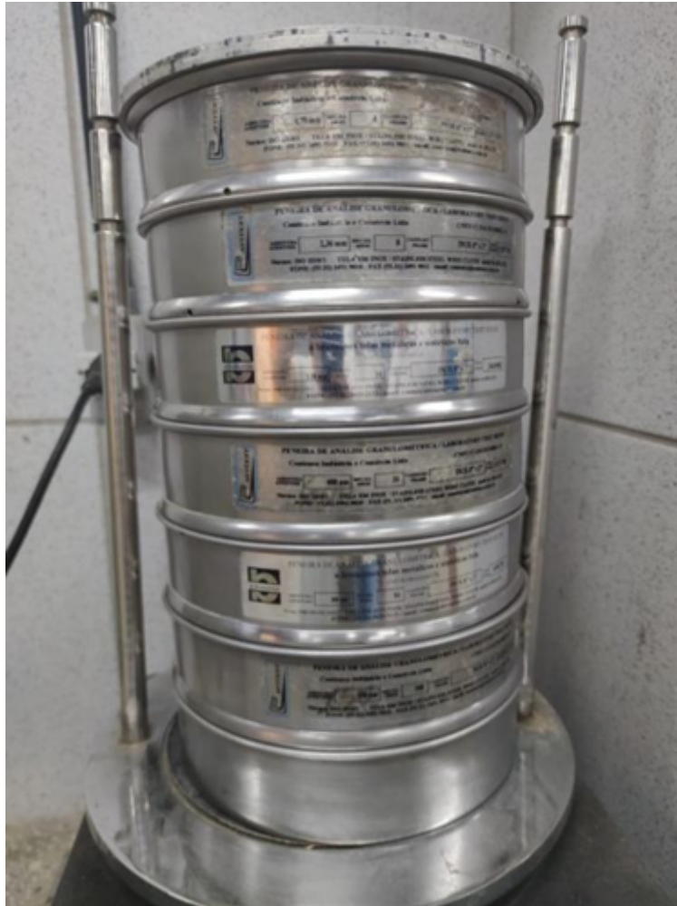
Figura 1 – processo de peneiramento do ensaio de granulometria.
