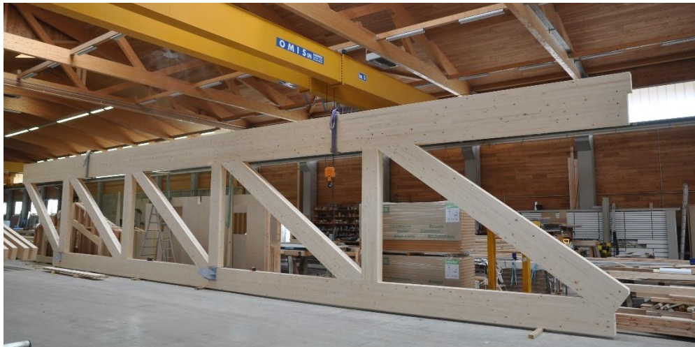
Poutres treillis – Atelier SIMONIN
