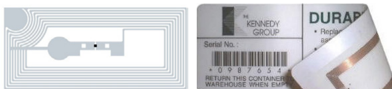
Figura 2 - Etiqueta (tag) RFID - Vista interna e externa
