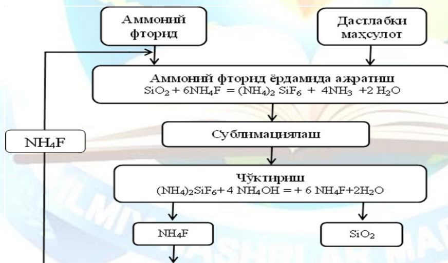
1-расм. Тадқиқот объектини кремнийсизлантириш схемаси
