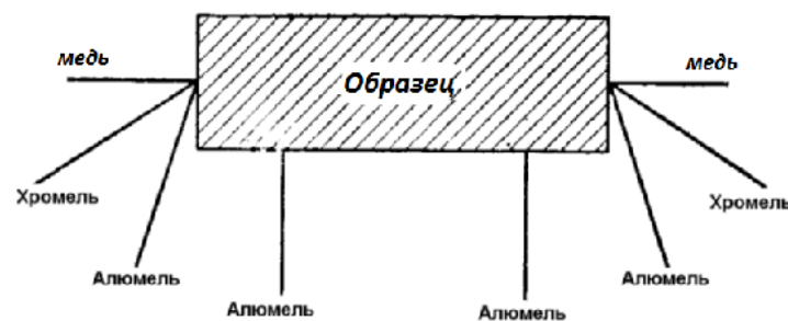
Рис. 9. Схема измерения теплопроводности термоэлектрических материалов методом Хармана
