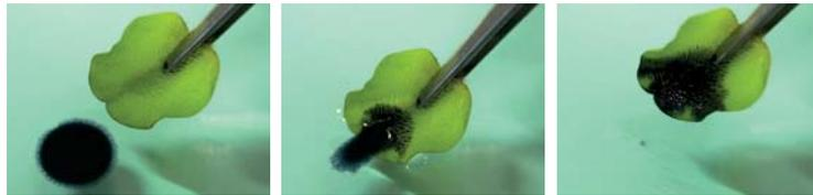
Öl-Adsorption an *Salvinia*. Kommt das Blatt mit dem im Wasser schwimmenden Öl in Kontakt, wird das Öl an der Oberfläche adsorbiert und transportiert.
