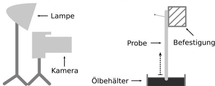
**Abbildung 7: Versuchsaufbau zur Messung der vertikalen Öltransporthöhe und -geschwindigkeit.** Die Richtung des Öltransportes ist durch die gestrichelte Linie angedeutet.
