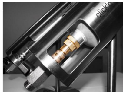
Abb. 48: Mobile Wasserstoffspeicher für E-Scooter auf Basis von Metall-Hydriden 73
