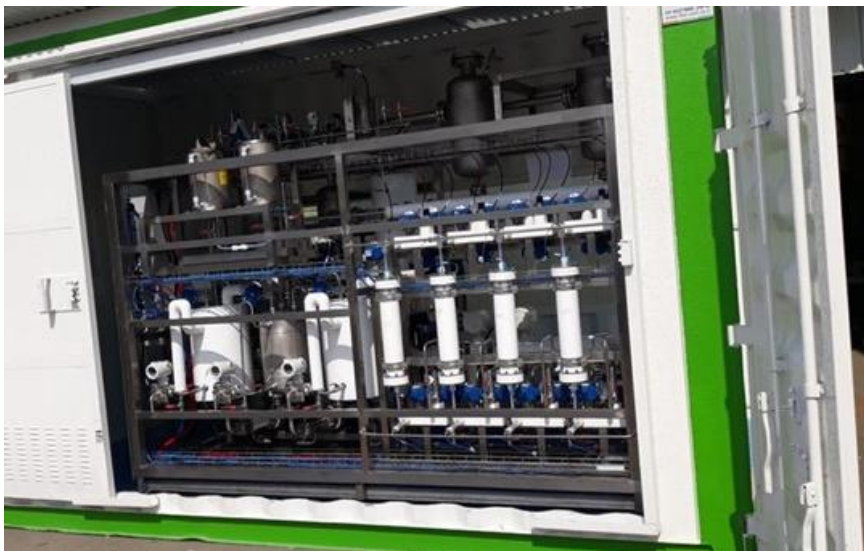
Abb. 9: Demonstrationsanlage der E-TAC Wasserspaltung basierend auf membranfreier Alkalischer Elektrolyse des Start-Ups H2PRO, Gewinner der Shell Energy Challenge 2020. 14
