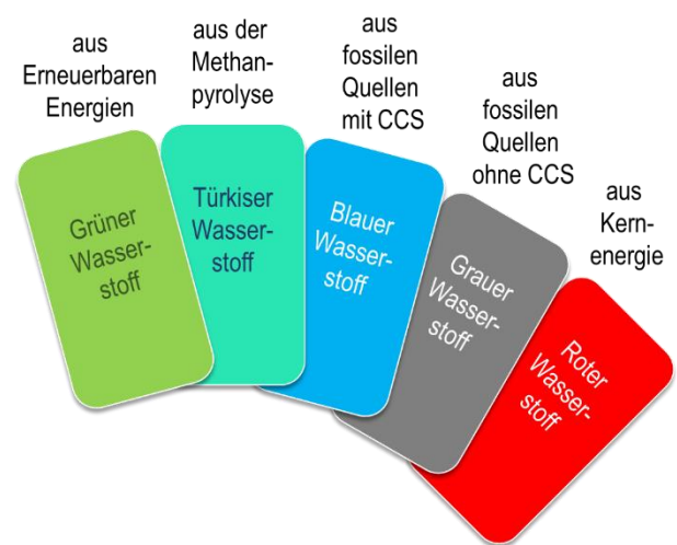
Abb. 1: Einteilung von Wasserstofferzeugungstechnologien nach der Herkunft des Wasserstoffs
