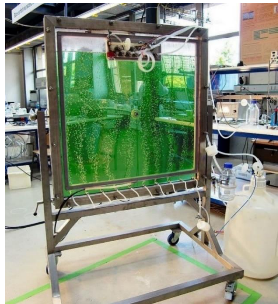
Abb. 26: Laborplattenreaktor für optimales Lichtmanagement zur Wasserstoffherzeugung mit Mikroalgenkulturen am KIT innerhalb des BMBF geförderten Forschungsprojekts "HydroMicPro". 42
