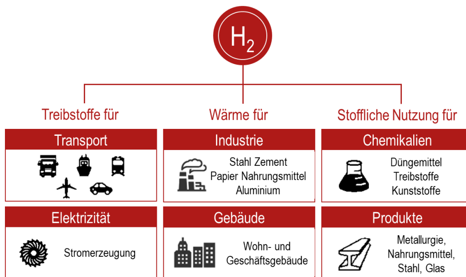
Abb. 65: Übersicht über unterschiedliche Wasserstoffanwendungen 125
