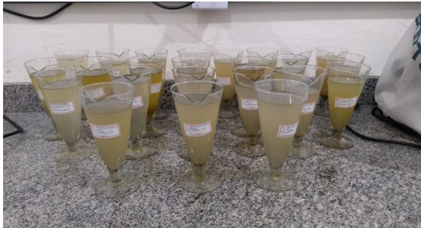
Figura 2 - Sedimentação espontânea em cálices cônicos
